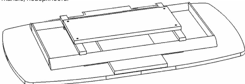
**3** От основания отклеить защитную пленку. Колонны прикрутить к покрытой нержавеющей части основания винтами M8x40. Наживить на все винты колонны к полке, выравнивая её, и закрутить болтами M8x50
